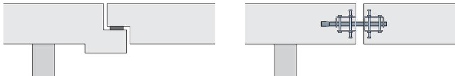
**Соединение плит перекрытия с консольной опорой (вертикальная проекция)**
